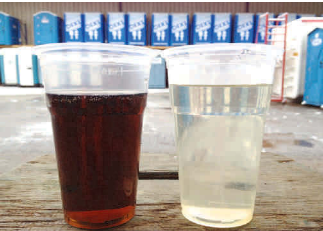
Abwasseraufbereitung: Wasservergleich vorher-nachher © Bluetector AG
